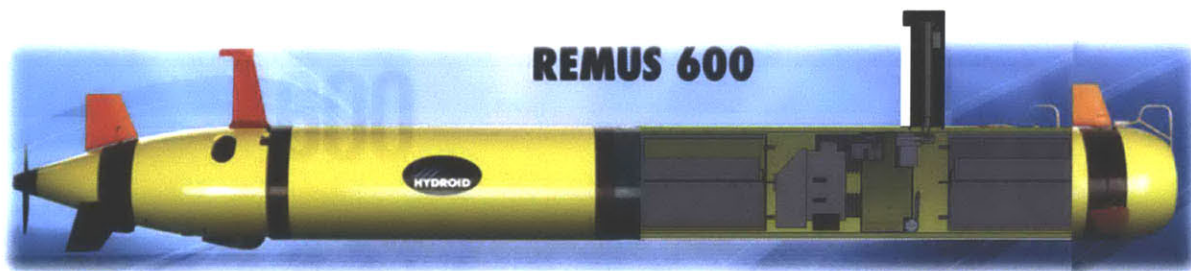
Figure 1: Remus 600 with new power system shown (MIT RDG, 2011)
