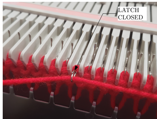
(d) The needle retracting while latch closing
