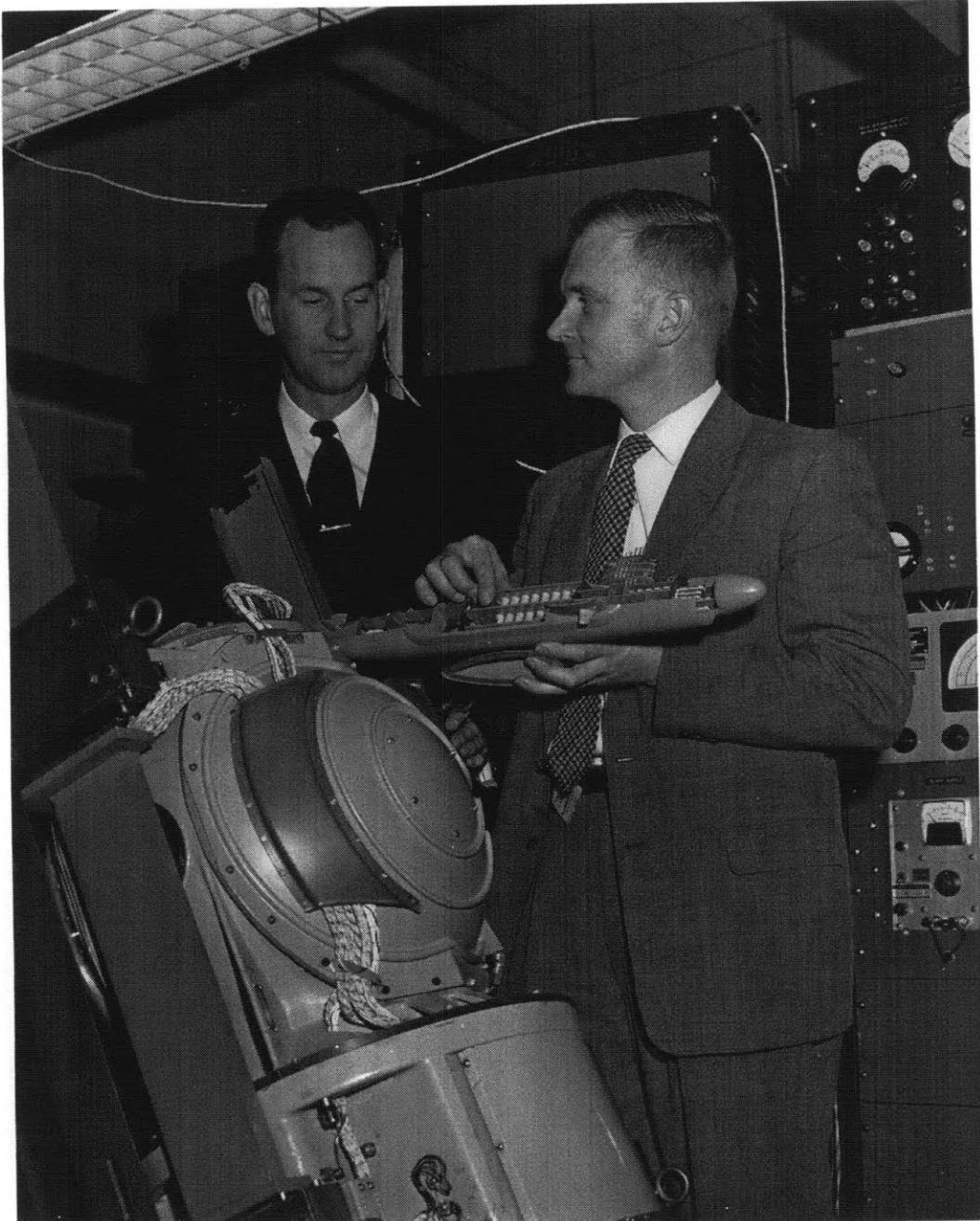
Fig 5 (MIT Museum Archives) Mark 1 inertial guidance capsule for Polaris, Fleet Ballistic Missile laboratory, MIT
