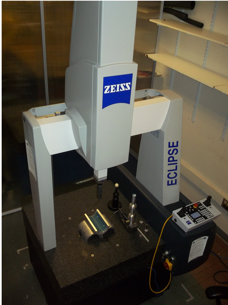
Figure 5-25: Zeiss Eclipse CMM Installed at MIT
