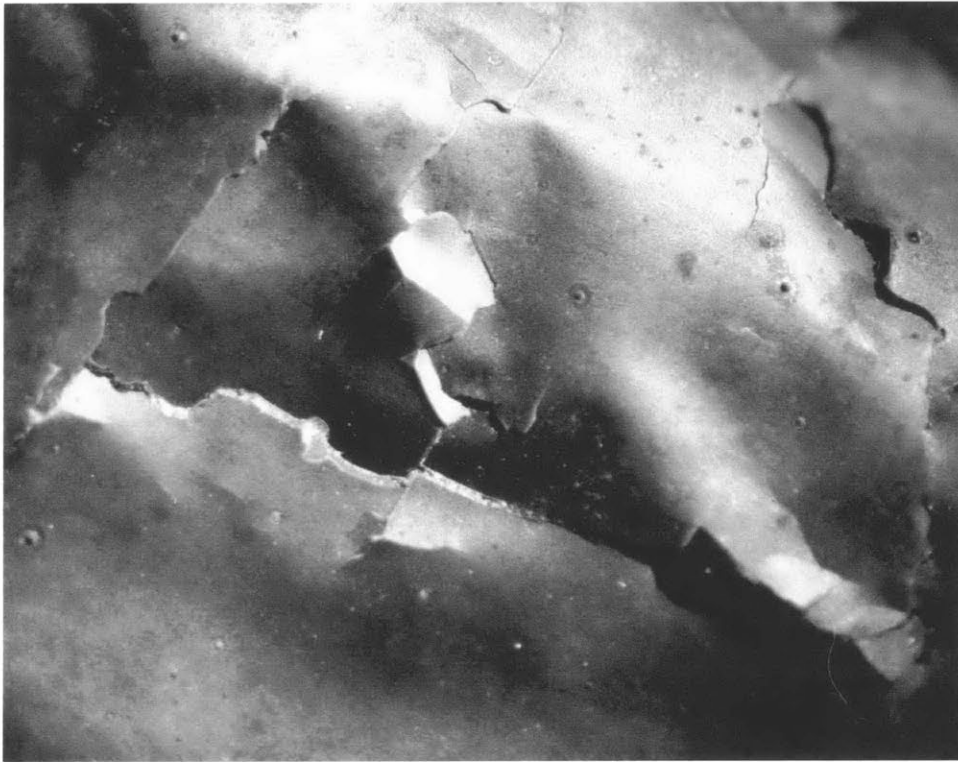
Figure 20. DH 2.2: Wrinkled cracked surface (x10).
