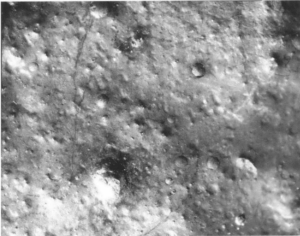
Figure 23. DH 2.8: Corroded surface (x10).
