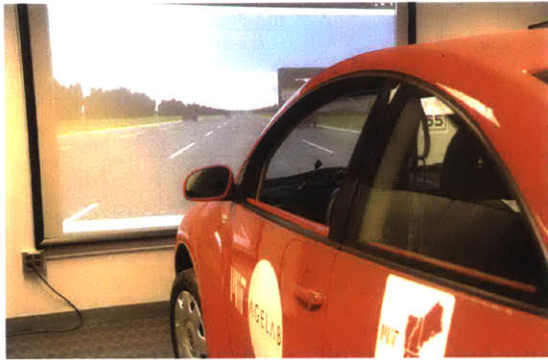
(a) MIT AgeLab fixed-base simulator user interface
