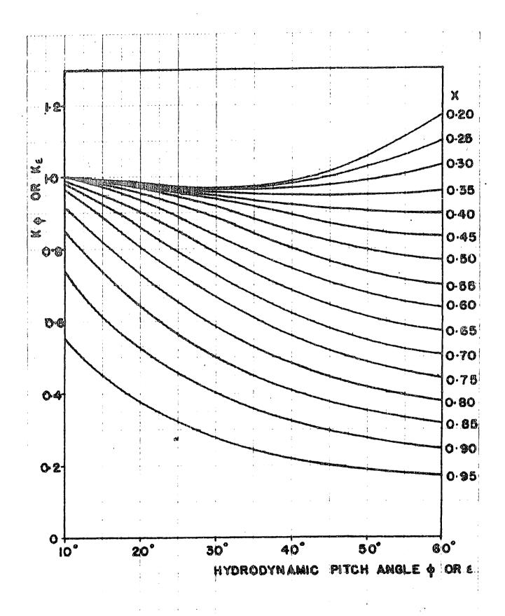
FIG. 14 .- GOLDSTEIN CORRECTION FACTOR FOR 3-BLADED PROPELLER
