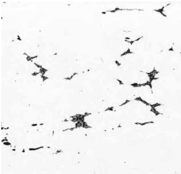
Fig. 5.20. Corte pulido de la hoja de un hacha de bronce con 8.06% de estaño. El eutectoide quebradizo exhibe líneas de fractura resultantes del excesivo trabajo en frío (amplificación: 200)
