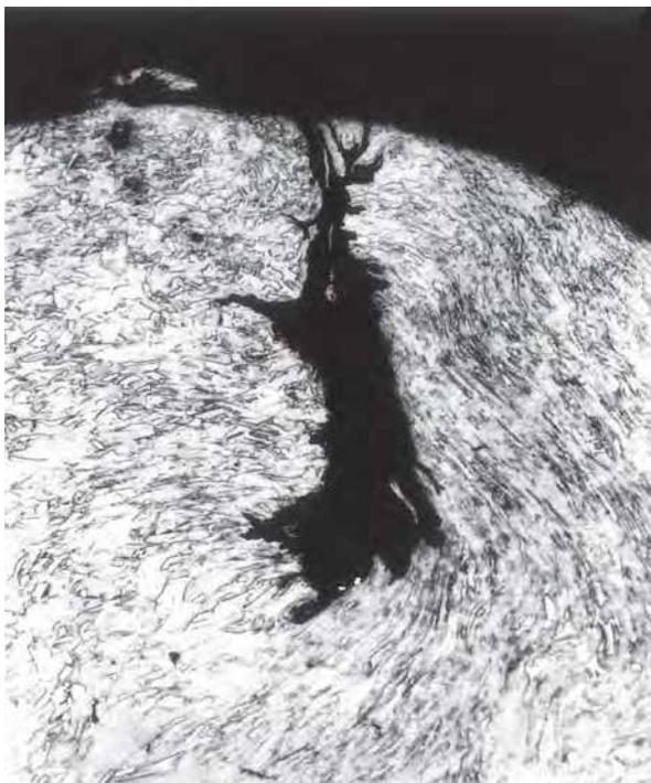
Fig. 3.25. Corte transversal de una aguja de ojo perforado, aproximadamente a la mitad del cuerpo. Muestra atacada con dicromato de potasio (amplificación: 100)
