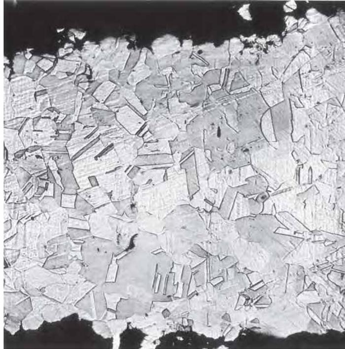
Fig. 3.12. Microestructura del corte transversal de una argolla de sección transversal rectangular, mostrando granos equiaxiales y maclas de recocido. Muestra atacada con dicromato de potasio (amplificación: 100)
