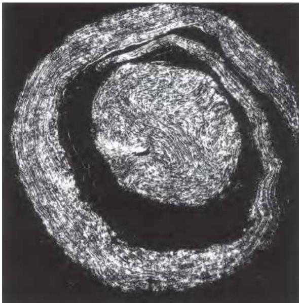
Fig. 6.7. Corte transversal de aguja de ojo de lazo (tipo b) de Ecuador. La lengüeta ovalada se asegura con las aletas laterales martilladas sobre su superficie. Muestra atacada con dicromato de potasio (amplificación: 100)
