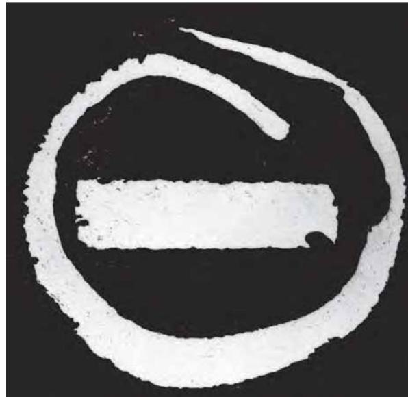
Fig. 6.6. Corte transversal pulido de una aguja de ojo de lazo (tipo 1a) del norte de Perú, de aleación de Cu-As, mostrando la aleta rectangular y el asta que la rodea. Muestra atacada con dicromato de potasio (amplificación: 100)
