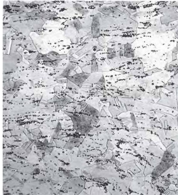
Fig. 3.9. Microestructura de un corte longitudinal de una argolla de sección transversal redonda del MRG. Se aprecian las maclas de recocido e inclusiones de óxido de cobre orientadas y alargadas. Muestra atacada con dicromato de potasio (amplificación: 200)
