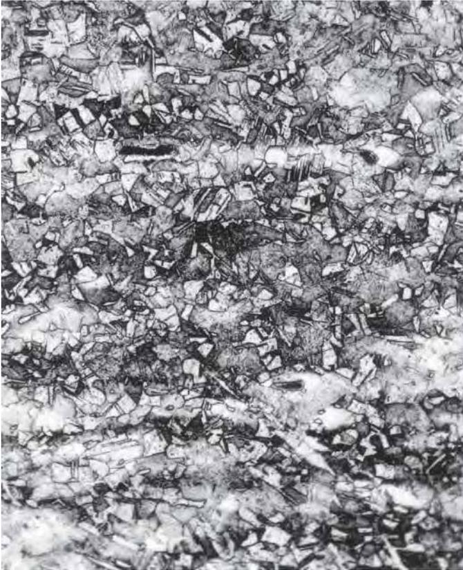
Fig. 5.7. Pinzas espiral. Corte transversal practicado hacia dentro del filo de la hoja, justo encima de la juntura de la hoja con la espiral. Nótese los granos equiaxiales con gemelos de recocido; hay marcas de esfuerzo en algunos granos. La estructura continua indica que la hoja y la espiral se formaron de una sola lámina de ese metal. Muestra atacada con dicromato de potasio seguido de cloruro férrico (amplificación: 100)
