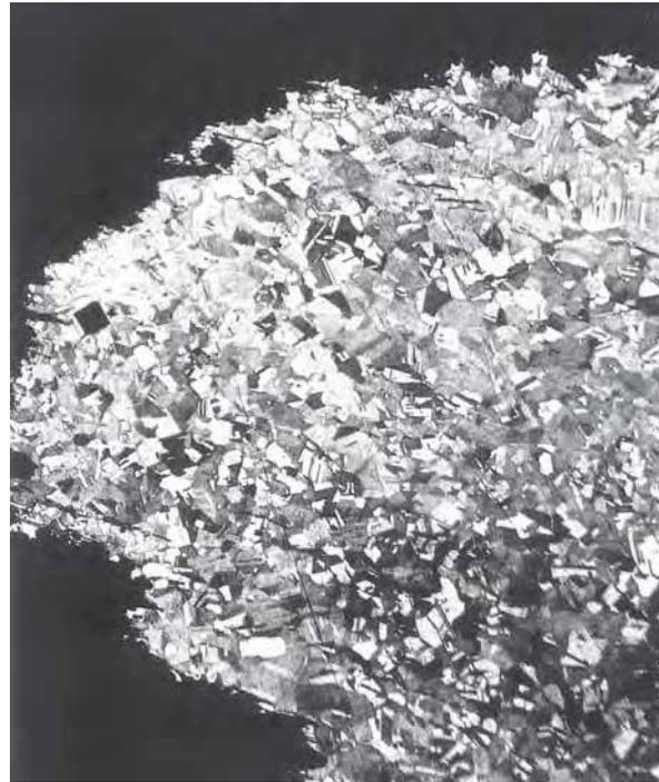
Fig. 3.19. Corte longitudinal de una hoja de hacha de cobre del MRG, dejada en condición de recocido. Nótese los granos equiaxiales y las maclas de recocido. Muestra atacada con dicromato de potasio (amplificación: 200)
