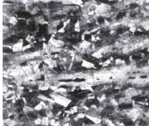
Fig. 5.8. Corte transversal realizado debajo de la sección presentada en la fig. 5.7, y más cerca, pero arriba de la juntura de la espiral con la hoja de la pinza. Nótese el eutectoide alargado que indica forjado en caliente, mientras la fase beta estaba estable. Muestra atacada con dicromato de potasio seguido de cloruro férrico (amplificación: 200).
