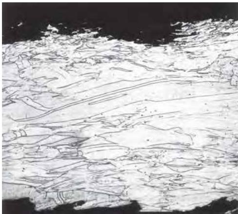
Fig. 3.14. Corte longitudinal de la hoja de una pinza de barra del Periodo 1 (MRG). La estructura es típica del cobre nativo martillado. Muestra atacada con dicromato de potasio (ampliación: 200)
