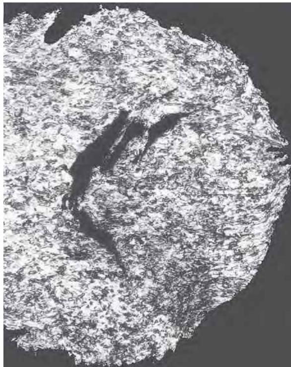
Fig. 3.31. Corte transversal del anzuelo, mostrando una fisura central. Muestra atacada con dicromato de potasio (amplificación: 50)
