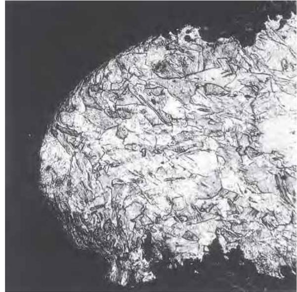
Fig. 3.29. Corte longitudinal cerca de la punta de un punzón. La orientación de los granos en la superficie es perpendicular al eje longitudinal, como resultado de la deformación por uso. Muestra atacada con dicromato de potasio (amplificación: 100)
