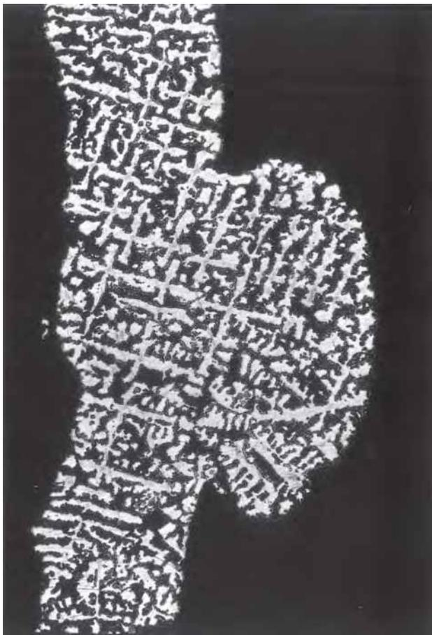
Fig. 5.3. Corte transversal de la pared y refuerzo de alambre de un cascabel de aleación de cobre-arsénico (12.28% As) del Periodo 2 (MRG). Muestra atacada con dicromato de potasio y ácido hidroclicórico (amplificación: 100)
