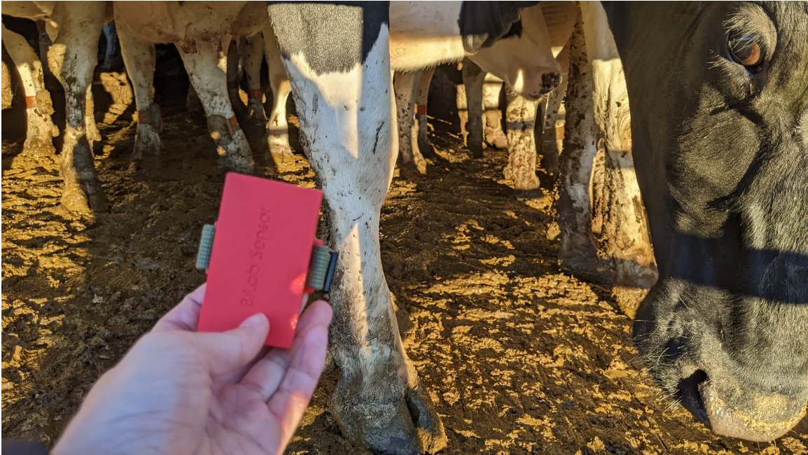
Figure 3-12: MIT IMU sensor compared to a cow metacarpus
