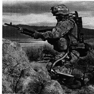
(d) Active Human Universal Load Carrier (HULC), a descendant of BLEEX [24]
