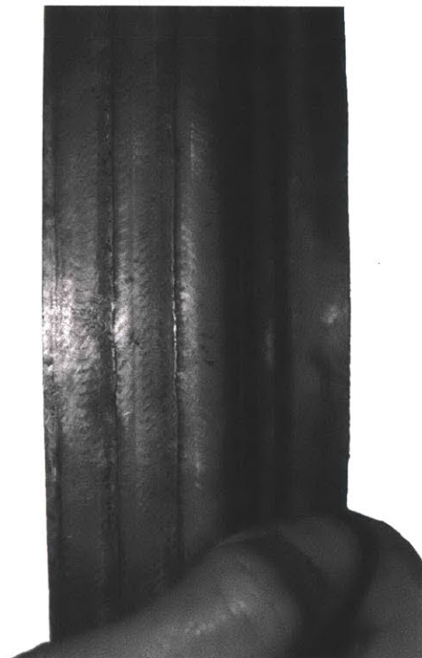
(d) OD-clad overlaid billet, weld bead
