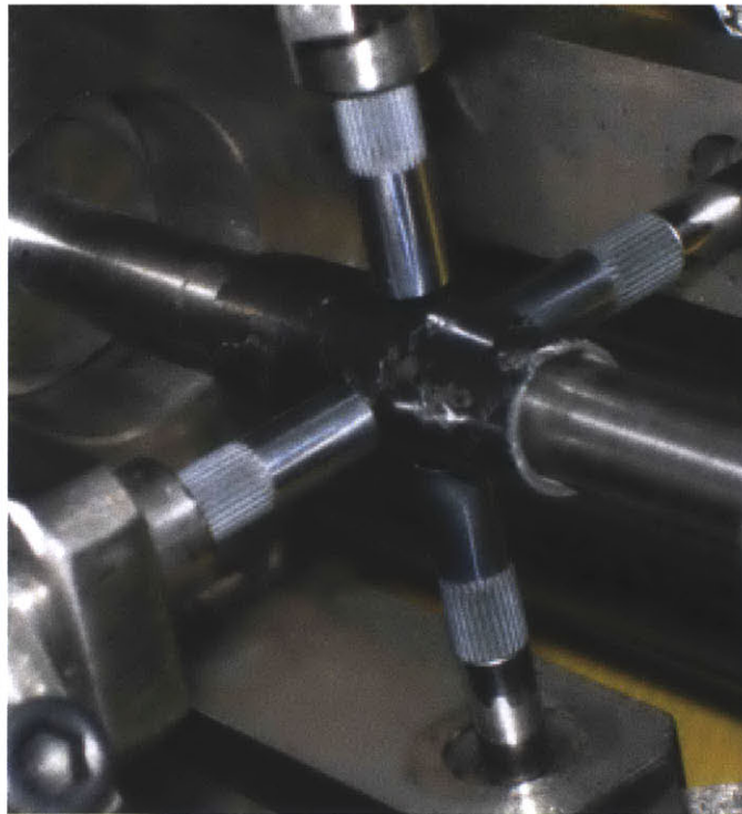
(d) 06-B after hoop test while still mounted on hoop test rig.
